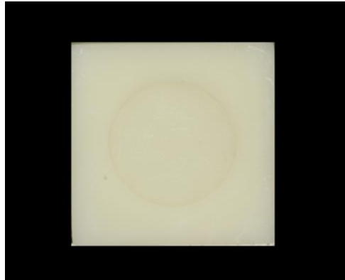
Figura 1. Espécime impressos em resina de impressão 3D (P Pro, Straumann) com rebaixo circular central (com profundidade variando em 0,2, 0,4, 0,6, 0,8 e 1mm) onde foi inserido o compósito.
