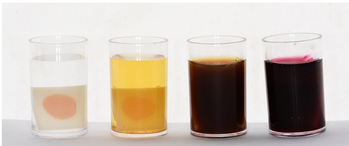
Figura 5. Espécimes imersos em diferentes soluções. Da esquerda para a direita estão as soluções de água destilada (grupo controle), chá preto, café e vinho tinto.
