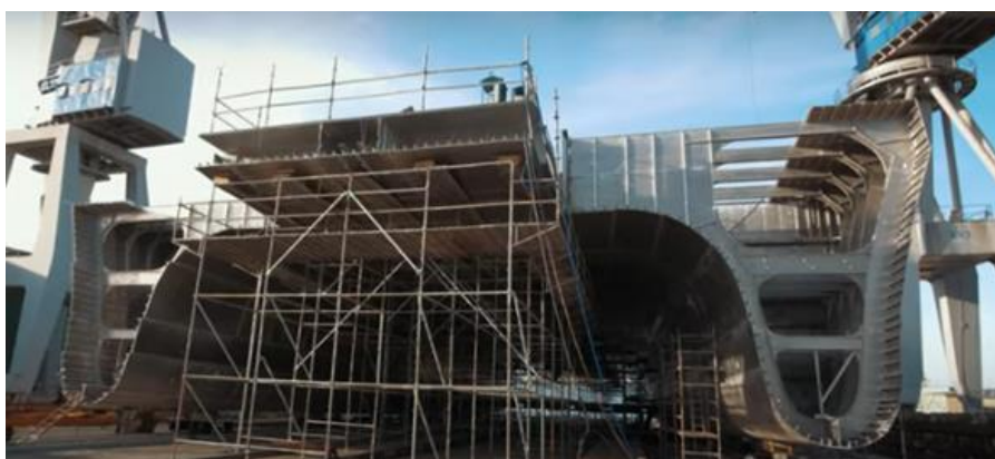
Figura 17 - Construção de um casco em alumínio
