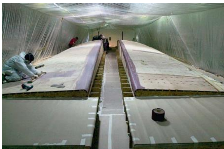
Figura 14 - Moldes de um casco Blubay 72
