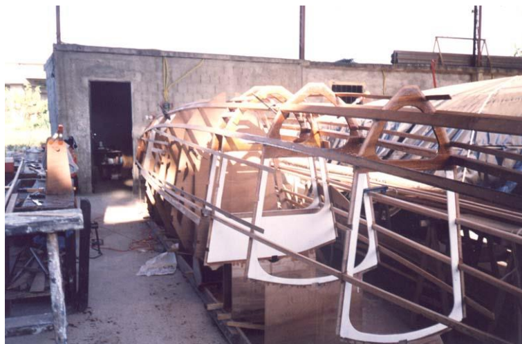
Figura 16 - Construção de um catamarã em madeira
