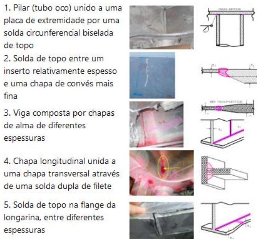
Figura 28 - Principais pontos de surgimento de trincas no alumínio
