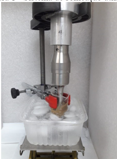
Figura 8 - Sistema de sonicação utilizado
