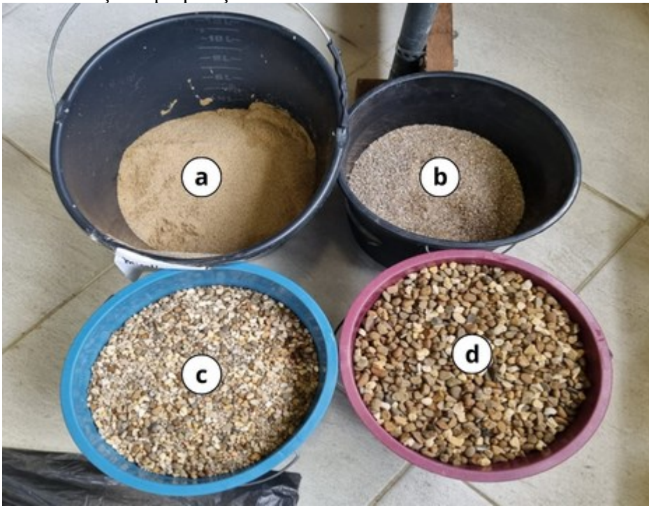
Figura 18 – Seleção e preparação dos materiais da camada filtrante e camada suporte
