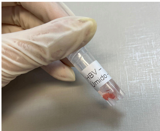
Figura 26 - Amostra DTS de HBV armazenada em ambiente úmido em estufa a 44,57°C
