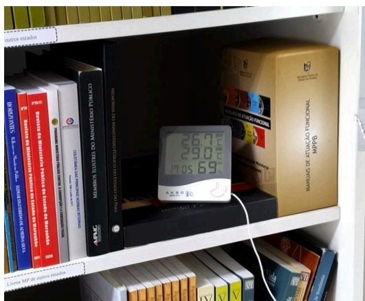
Figura 17: Termo Higrômetro Reserva Técnica do Memorial do MPSC
