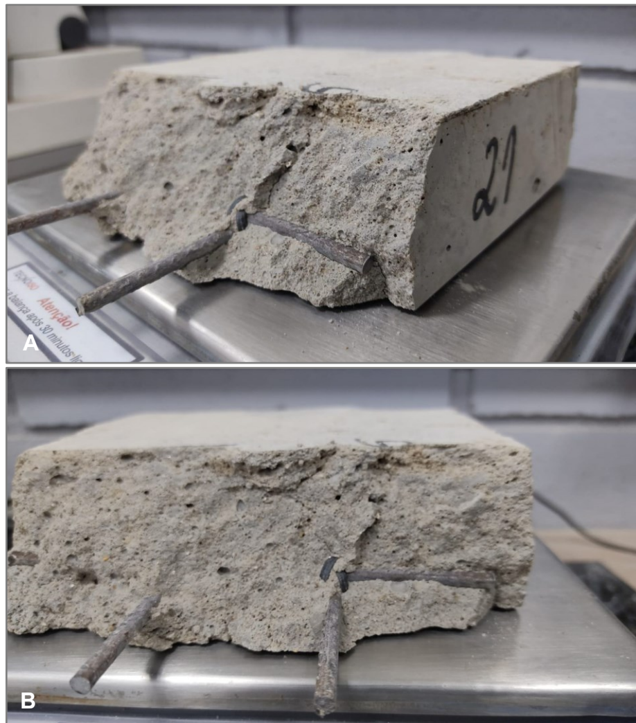
Figura 36 – A) e B) Corpo de prova armado com aço após o rompimento à tração na flexão.
