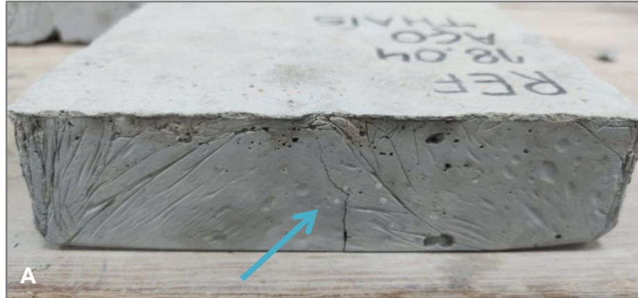
Figura 29 – A) Rompimento com armadura de aço com visão lateral do corpo de prova; B) e C) Rompimento com armadura de aço com visão inferior do corpo de prova.
