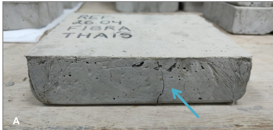
Figura 32 – A) Rompimento com armadura de fibra de vidro com visão lateral; B) e C) Rompimento com armadura de fibra de vidro com visão inferior do corpo de prova.
