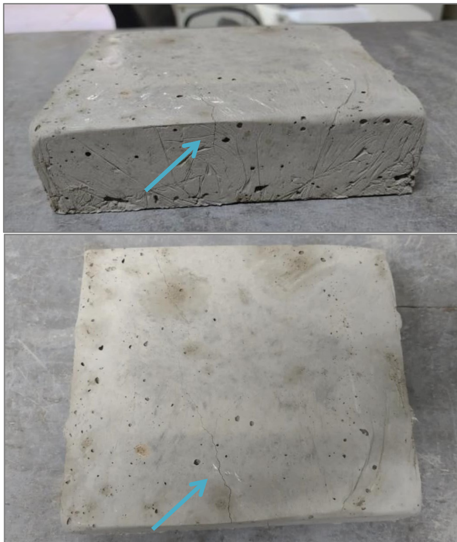
Figura 27 – Rompimento com armadura de aço com visão inferior do corpo de prova.
