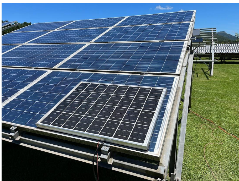
Figura 15 – Imagem do módulo de referência utilizado durante os ensaios de curva IV.
