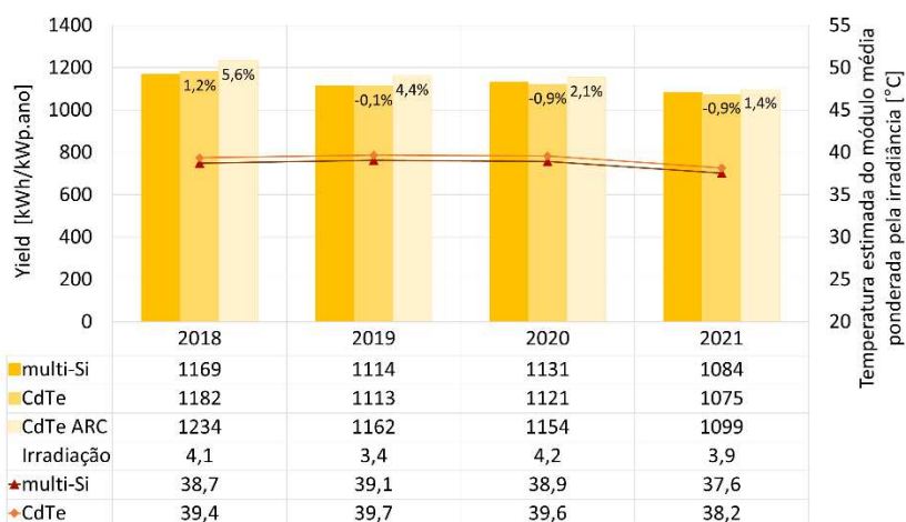
Figura 6 - Produtividade anual no período analisada para os três sistemas FV avaliados neste estudo, temperatura estimada do módulo média ponderada pela irradiação e irradiação média diária inclinada (27,4°).
