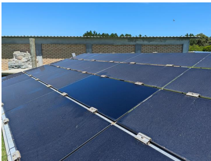
Figura 27 – Módulo de CdTe com ARC com a película antirreflexo removida, em comparação com os demais módulos do mesmo sistema.
