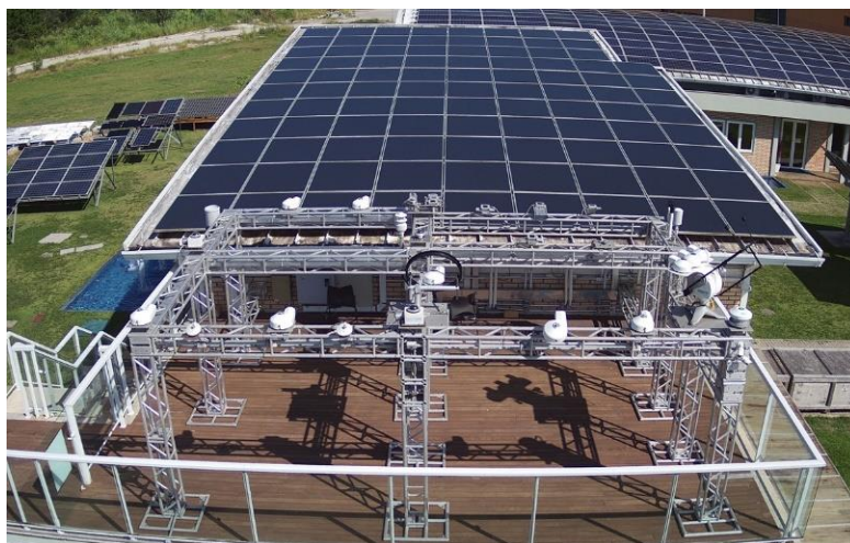
Figura 2 - Imagem aérea da estação solarimétrica localizada no laboratório Fotovoltaica-UFSC em Florianópolis-SC (27,4°S, 48,4°O).
