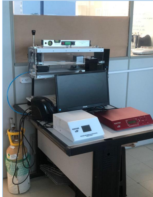
Figura 7. Na imagem, podemos observar o circuito fechado e a esteira metabólica, conectada ao analisador de gases e o cilindro de oxigênio que foi utilizado durante os dias de calibração.
