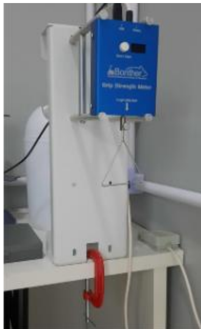
Figura 10. Aparato de avaliação de força dos animais. Capaz de analisar tempo de preensão, pico de força e queda da força. O triângulo é o suporte onde os animais realizam a preensão, sendo disparado o sinal para captação de força ao apertar um pedal
