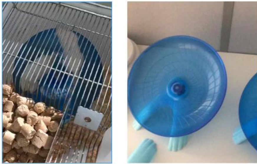
Figura 6. Roda de corrida utilizada para o treinamento aeróbico durante 6 semanas. Ao lado esquerda, podemos observar um grupo sendo monitorado durante a limpeza do biotério. Ao lado direito, a roda de corrida com seu suporte inferior que faz a roda girar, sendo este retirado nos grupos dos animais sedentários.
