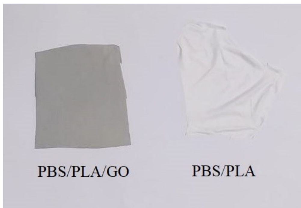
Figura 6. Fotografia dos filmes poliméricos de microfibras.
