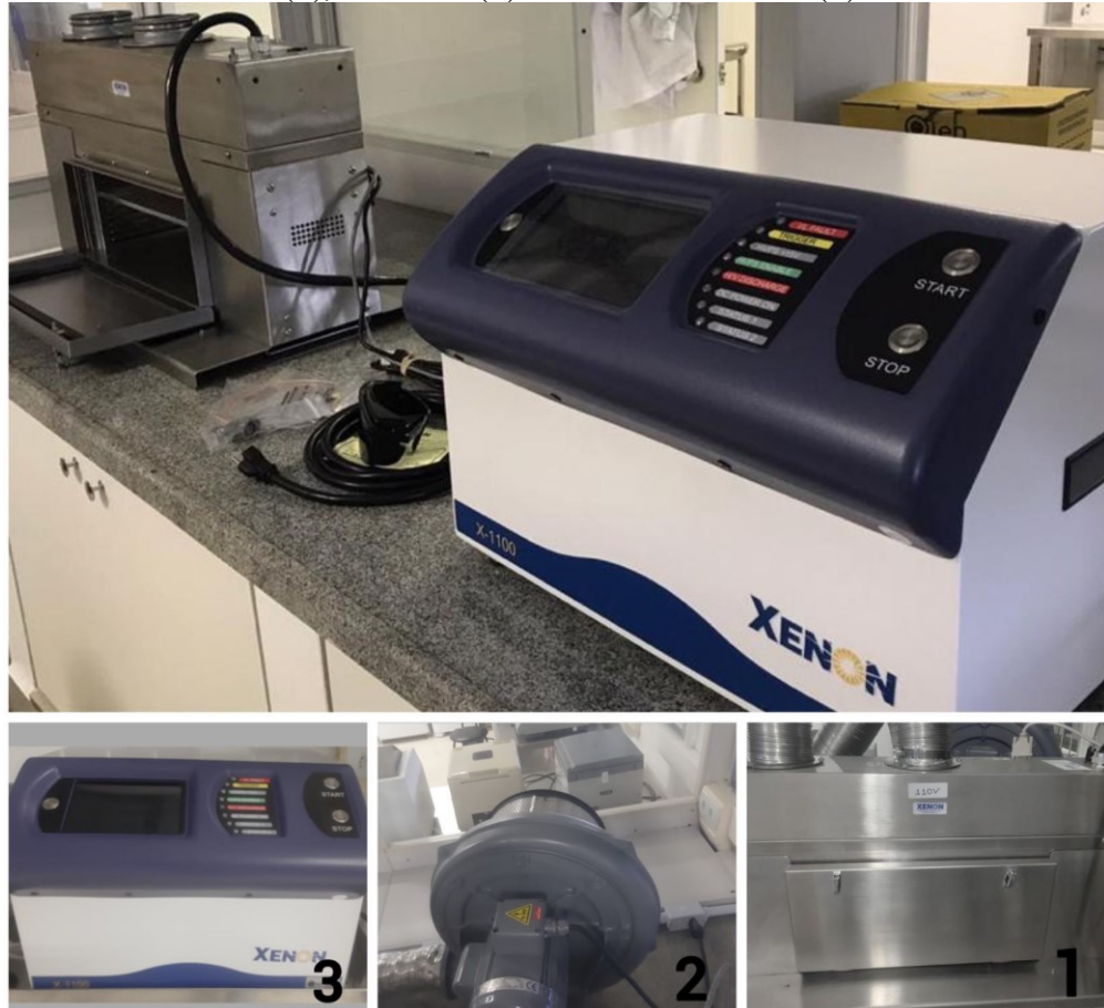
Figura 2- Equipamento de luz pulsada da Xenon, modelo X-1100. A fotografia da parte superior é uma visão geral do equipamento. Na parte inferior são mostradas: Câmara de tratamento (1), Exaustor (2) e Painel de controle (3).
