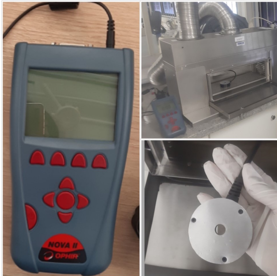
Figura 4 - Radiômetro utilizado para medir as fluências em função dos parâmetros de operação e da posição da amostra no interior da câmara de tratamento.
