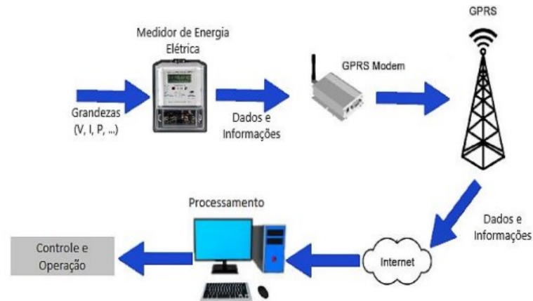
Figura 9 – Arquitetura para implantação de telemetria de energia
