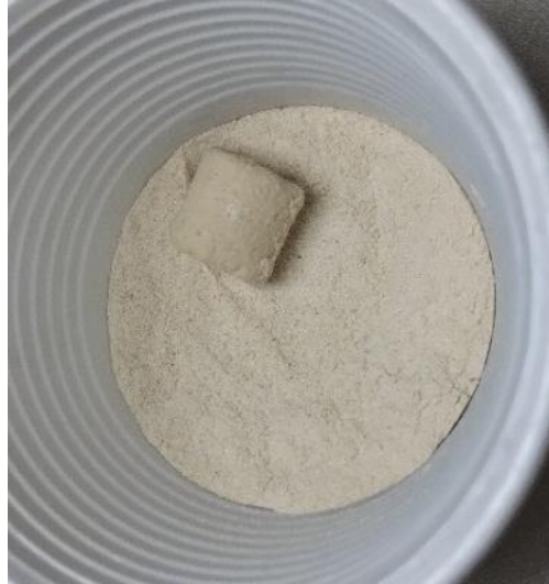
Figura 5 – Aplicação do revestimento com gesso em pó
