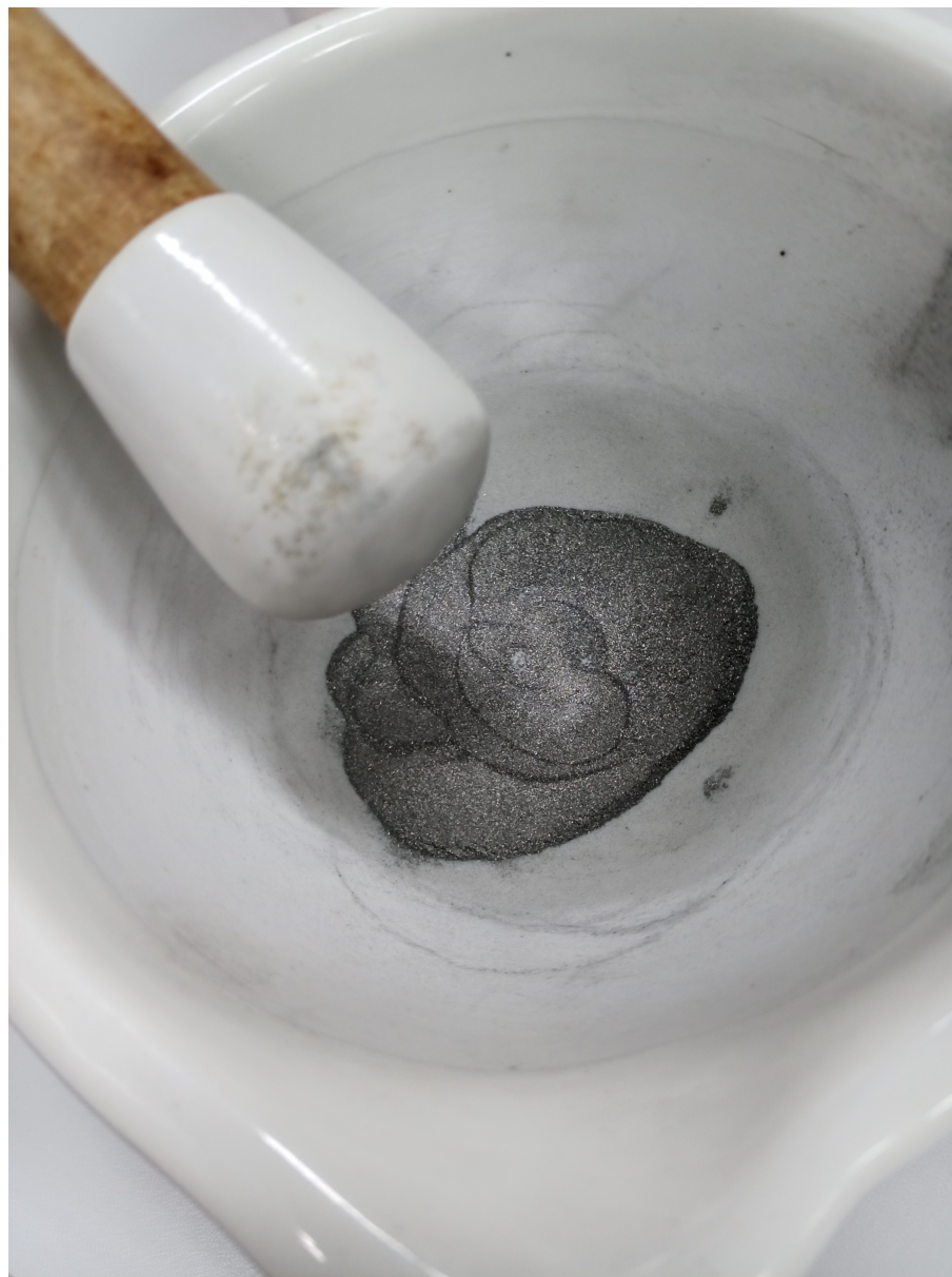
Figura 13 – Preparo das partículas metálicas
