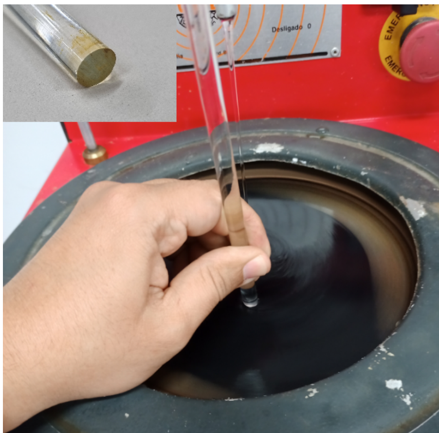
Figura 17 – Polimento do bastão de vidro para que ele possa ser empregado como uma lente
