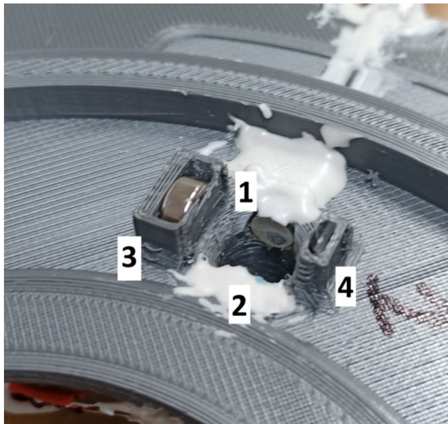
Figura 32 – Protótipo de anel de fixação impresso, com destaque para a fixação dos componentes: [1] lente fixada na câmera; [2] lente que fixada no LED; [3] ímã permanente; [4] sensor Hall
