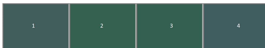
Figura 20 – Exemplo de variação gerada pela mesma câmera demonstrada por meio de imagens de uma amostra de graxa adquiridas a cada dois minutos sem nenhum efeito externo ou alteração por conta do ambiente
