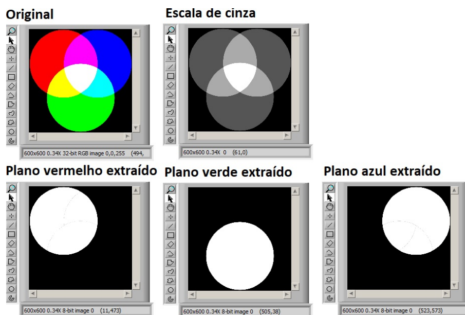
Figura 21 – Exemplo de extração de plano de cores vermelho, verde e azul respectivamente utilizando a biblioteca de extração de planos do software Labview
