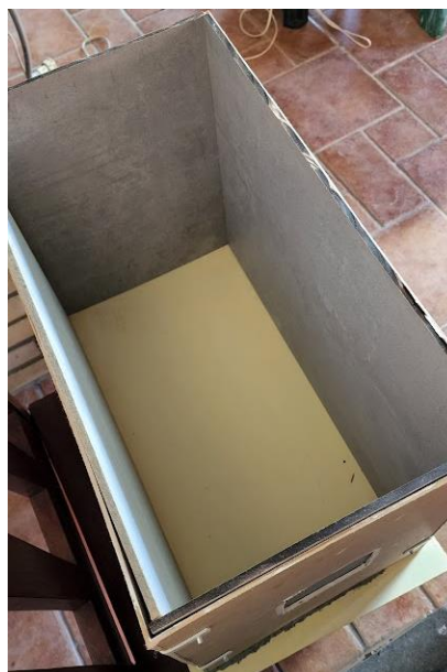
Figura 27 - Nova maquete com 6mm a mais em cada lado para o encaixa das chapas de revestimento (tampa removível)
