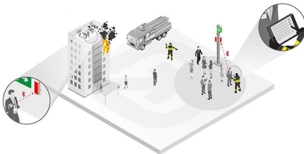
Figura 5 – Desenho esquemático da aplicação de um sistema de evacuação por aplicativo
