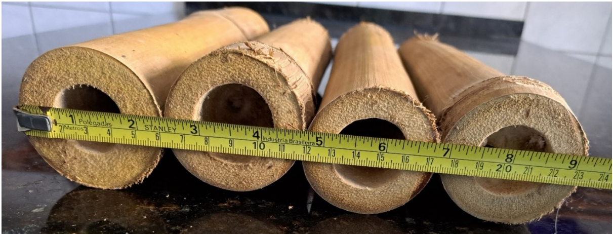
Figura 108 - Medidas da seção transversal dos colmos de bambu - Dendrocalamus asper .
