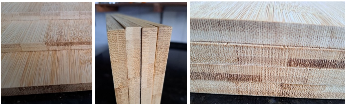
Figura 113 - Chapa de bambu, com detalhes das superfícies.
