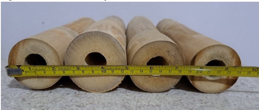
Figura 111 - Medidas da seção transversal dos colmos de bambu - Guadua chacoensis .
