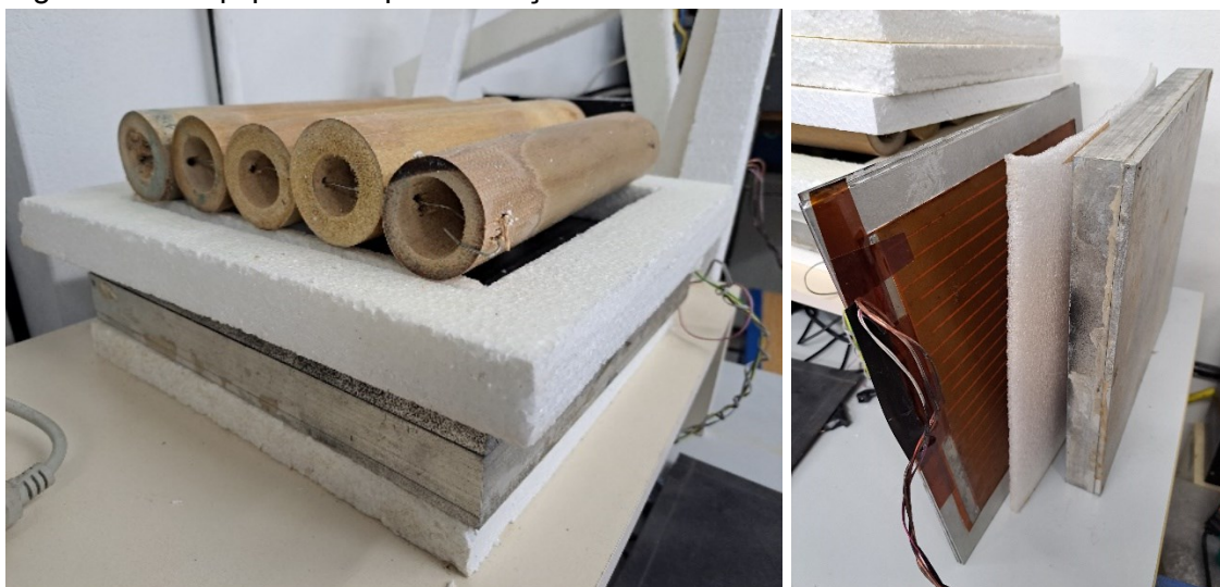
Figura 114 - Equipamento para medição da resistência térmica dos colmos de bambu.
