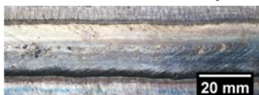
Figura 35 – Aspecto superficial dos cordões de solda realizados com velocidade de alimentação de arame de 2,5 m/min
