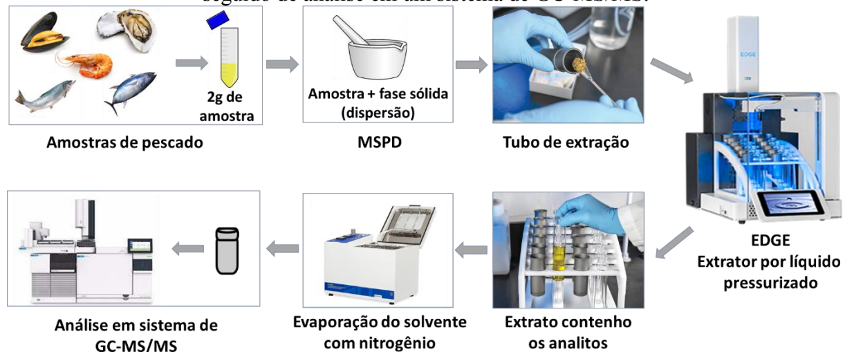
Figura 8- Processo de preparo e extração das amostras de pescado usando MSPD e PLE, seguido de análise em um sistema de GC-MS/MS.
