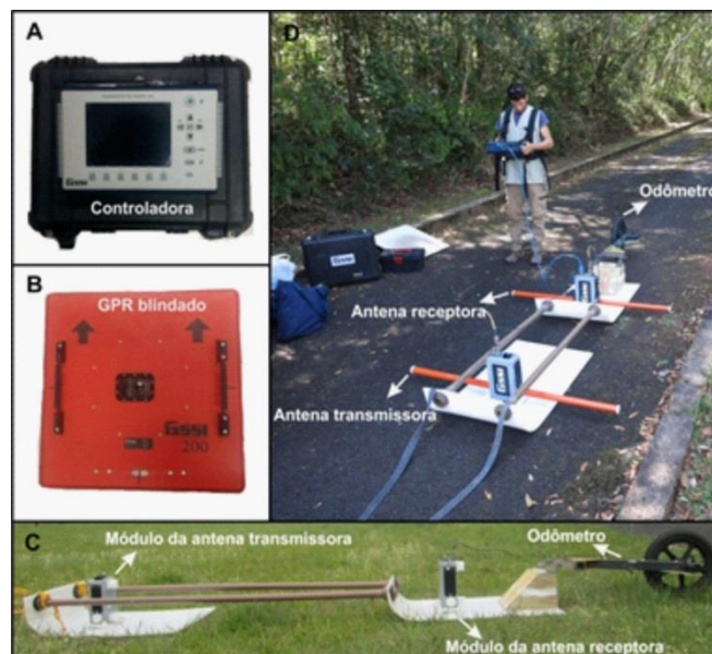
Figura 20. - Sistema GPR: A) Controladora; B) Antena de 200 MHz blindada; C) Módulos eletrônicos das antenas; D) Sistema GPR de baixa frequência não blindado. Fonte: Lemos (2017)
