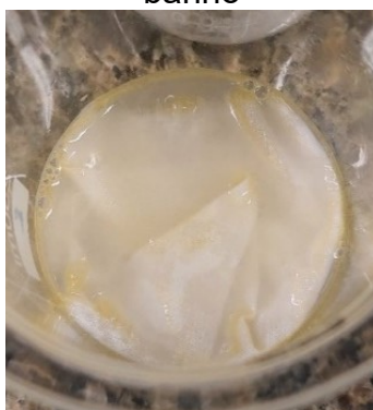
Figura 27 - Óleo de neem acumulado na superfície do tecido durante o período de banho
