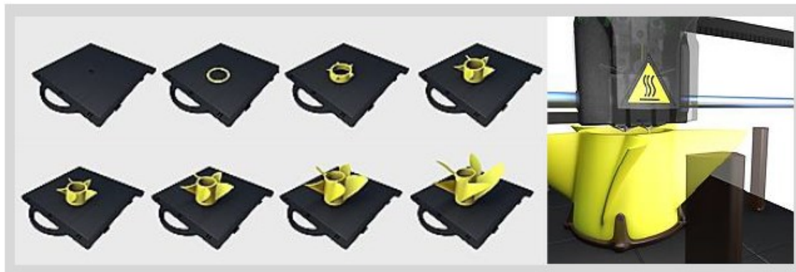
Figura 13: Evolução do processo de fabricação de hélices utilizando a tecnologia FDM (BLANCO, 2019).
