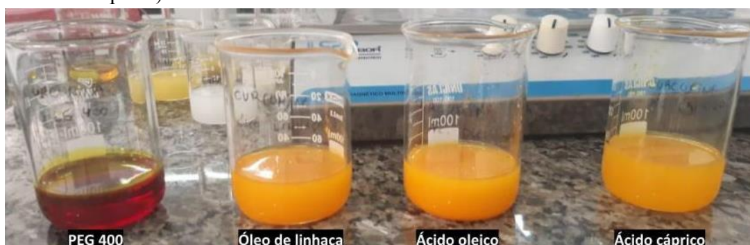
Figura 5: Solubilização da curcumina nos solventes avaliados (PEG, óleo de linhaça, ácido oléico e ácido cáprico).
