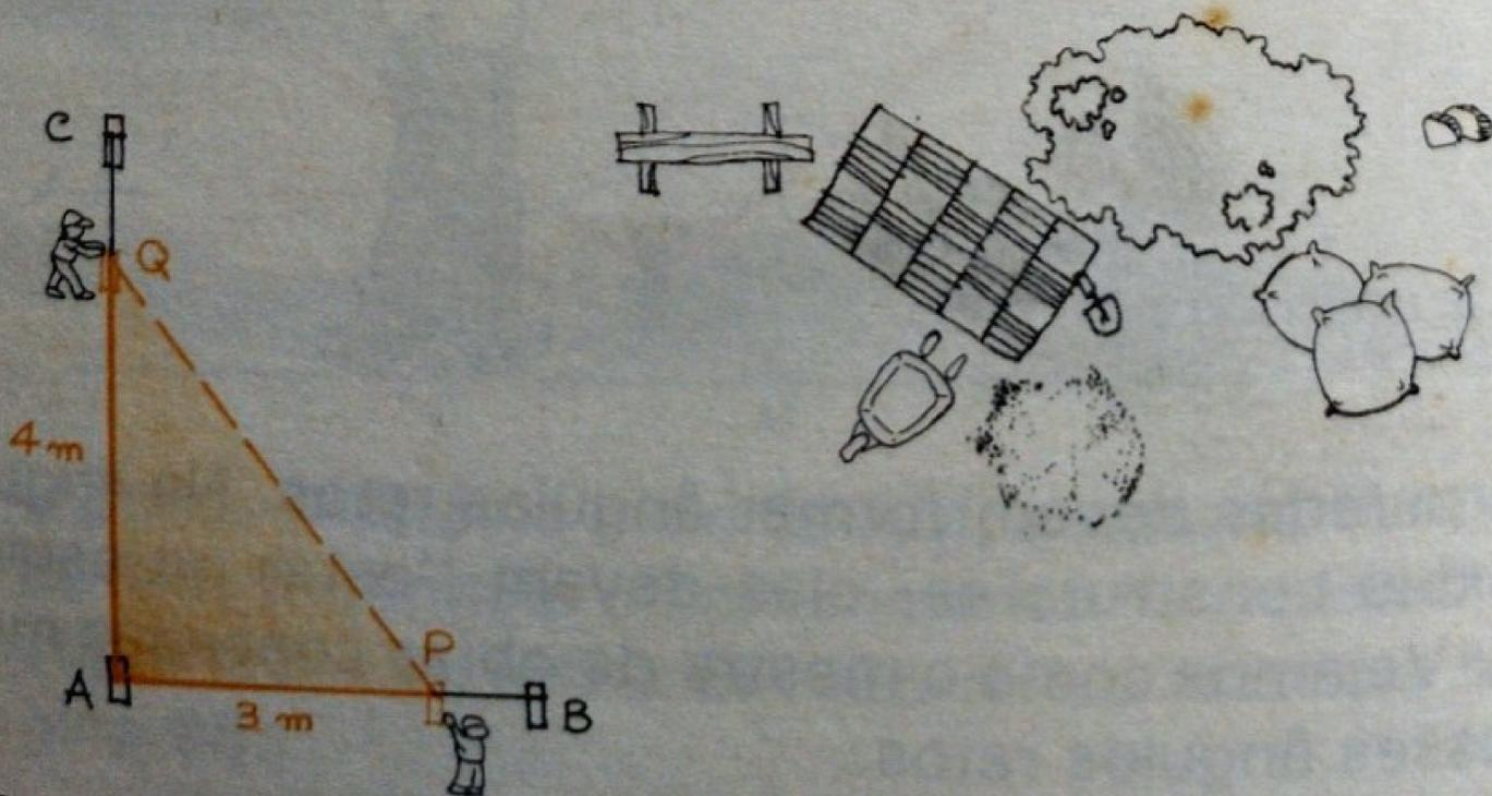
Se essa distância medir exatamente 5 m, é sinal de que o mestre acertou na primeira! O ângulo formado pelos fios AB e AC mede precisamente  $90^\circ$ . Portanto as paredes que serão construídas em AB e AC "estarão no esquadro".
