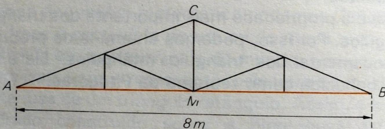
O comprimento da viga CM depende da inclinação do telhado. Quanto mais inclinado for o telhado, maior será a viga CM.
