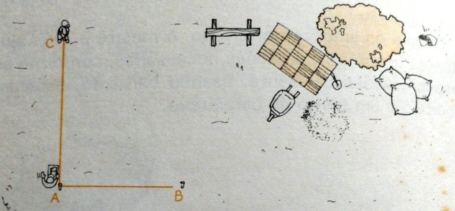
Usando apenas sua sensibilidade e sua experiência, o mestre determina onde o ajudante deve cravar a estaca C, de maneira que o fio AC fique perpendicular ao fio AB.
