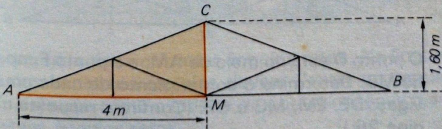
Agora vamos calcular o comprimento da viga AC, que deve ter o mesmo comprimento da viga CB. Como o triângulo AMC é retângulo, podemos usar o teorema de Pitágoras. Já sabemos que AM e CM, que são os catetos, medem 4 m e 1,6 m, respectivamente. Para calcular a hipotenusa AC, escrevemos:
