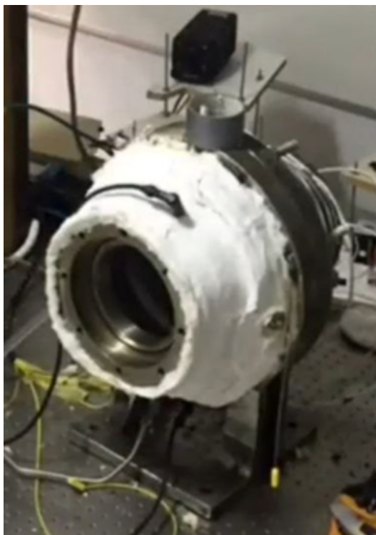
Figura 30 – CVR coberto por lã de rocha
