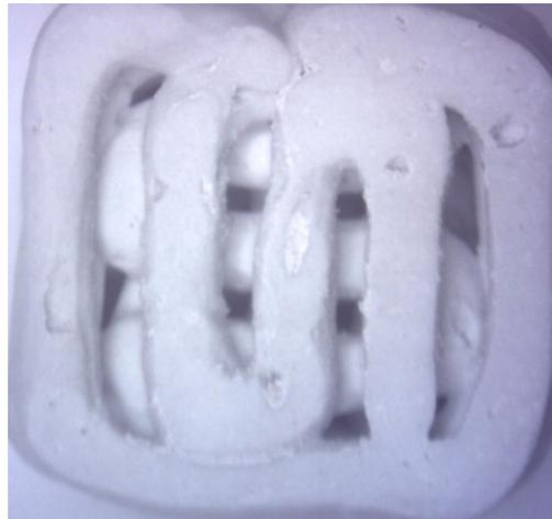
Figura 20 - Imagem de microscopia óptica de um *scaffold* de HAp+ $\text{Nb}_2\text{O}_5$  com aumento de 30x para a medição do tamanho dos poros pelo software CaptureR.
