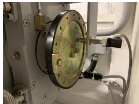
(b) Enfoque na estrutura para simulação de desbalanceamento. Exemplo com uma única peça fixada.
