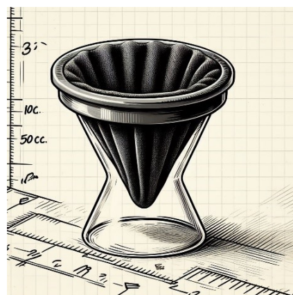
Figura 18– Modelo de geotêxtil adaptado pela autora para uso em bancada
