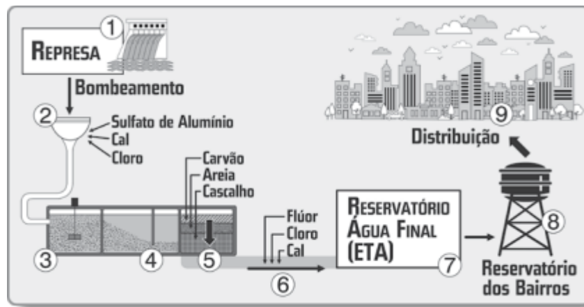
Figura 6 – Esquema simplificado do tratamento e distribuição da água tratada
