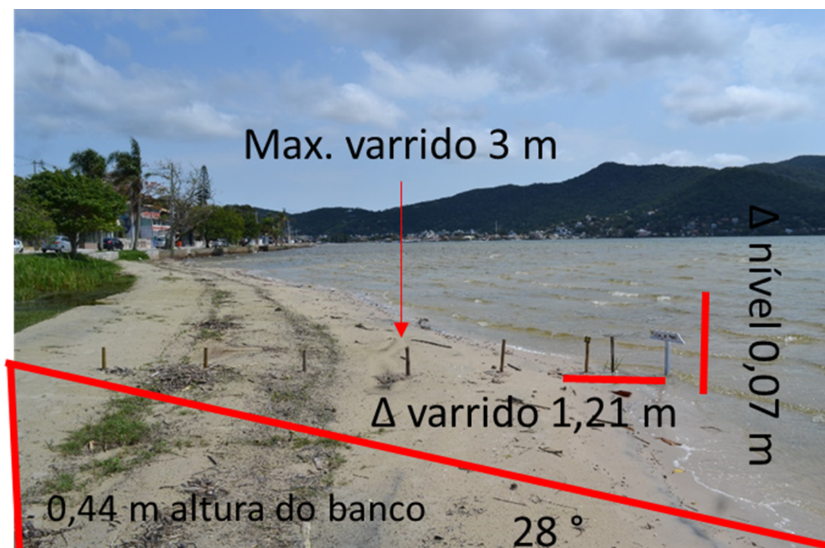
Figura 4. Características de inclinação, zona de varrido e variação de maré do baixio vegetado em setembro/outubro de 2021. Detalhe para as linhas do deixa anteriores e zona do varrido medida nos meses citados (Imagem: PES).
