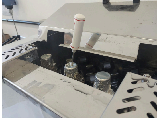
Figura 14 - Amostras sendo digeridas pelas enzimas no banho Dubnoff.
