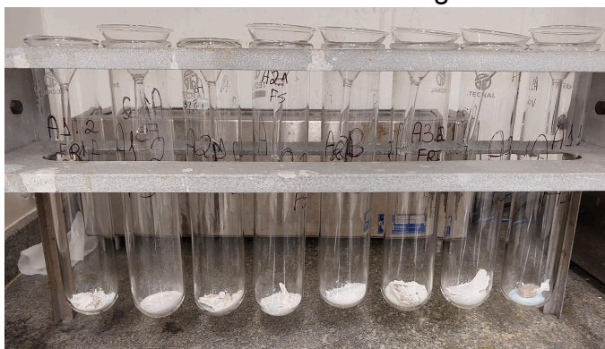
Figura 20 - Tubos de extração contendo o celite e as fibras solúveis e insolúveis de cada amostra antes da digestão.
