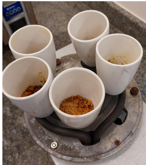
Figura 7 - Processo de carbonização dos cadinhos contendo as amostras em chapa de aquecimento.
