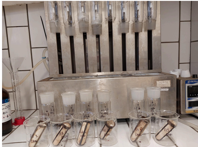
Figura 13 - Cartuchos de celulose com as amostras e balão de extração antes de serem acoplados ao equipamento de extração de lipídios por Goldfish.
