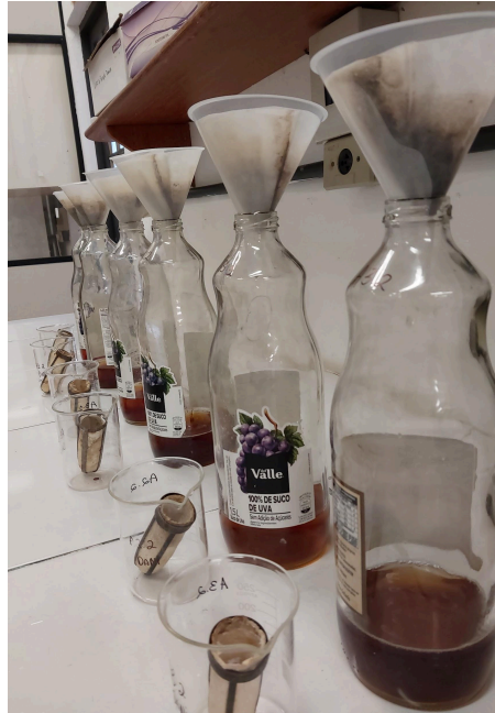
Figura 12 - Filtração das amostras com água destilada.
