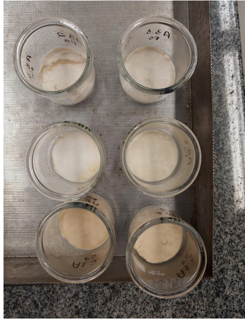
Figura 18 - Cadinhos de fibra solúvel após 1h na estufa.
