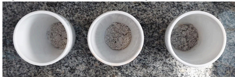
Figura 8 - Amostra após incineração na mufla.
