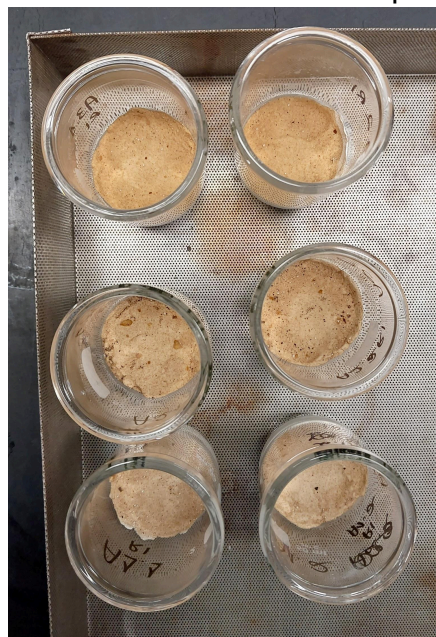
Figura 19 - Cadinhos de fibra insolúvel após 1h na estufa.
