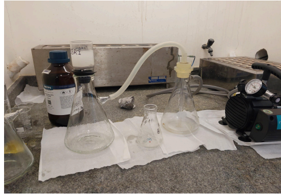
Figura 16 - Cadinho de fibras no sistema de filtração a vácuo.
