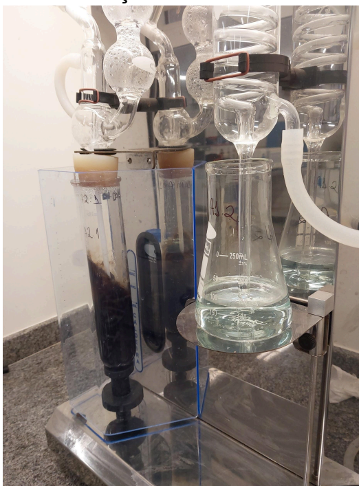
Figura 10 - Destilação e neutralização da amostra e coleta no erlenmeyer.
