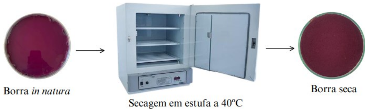
Figura 3 – Processo de secagem da borra de vinho tinto
