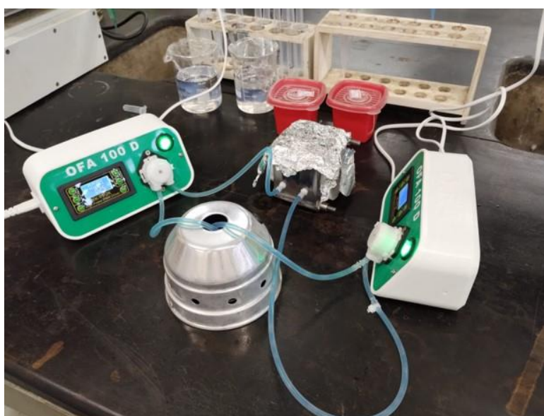
Figura 16- Sistema em fluxo utilizado para os testes de Foto-Fenton e de Fotocatálise Heterogênea.
