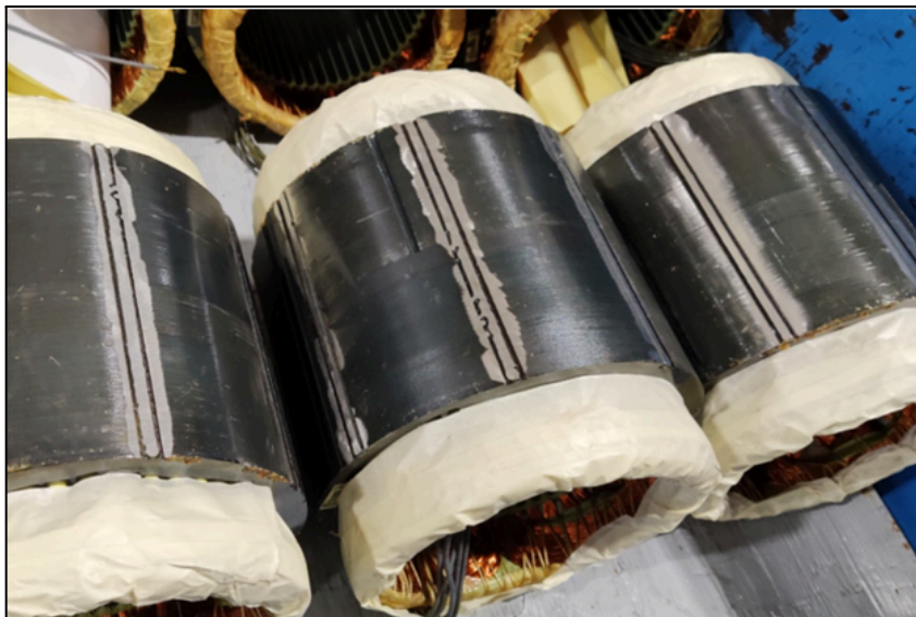
Figura 13 - Estatores bobinados soldados com MIG e lixados com disco flap.
