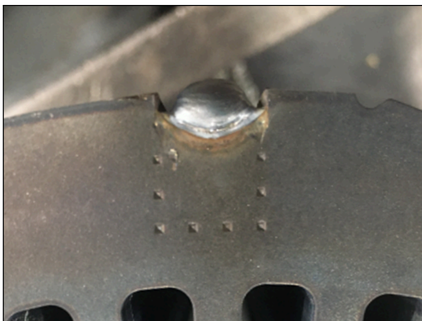
Figura 12 - Perfil transversal do cordão de solda ultrapassando o diâmetro externo do pacote.
