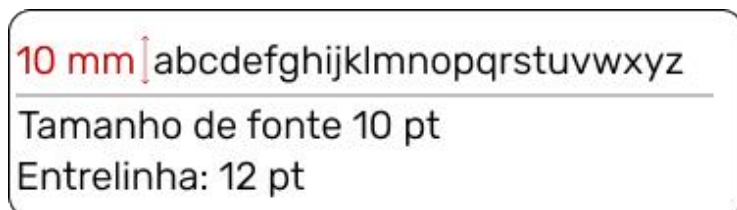
Figura 45: Espaçamento das entrelinhas
