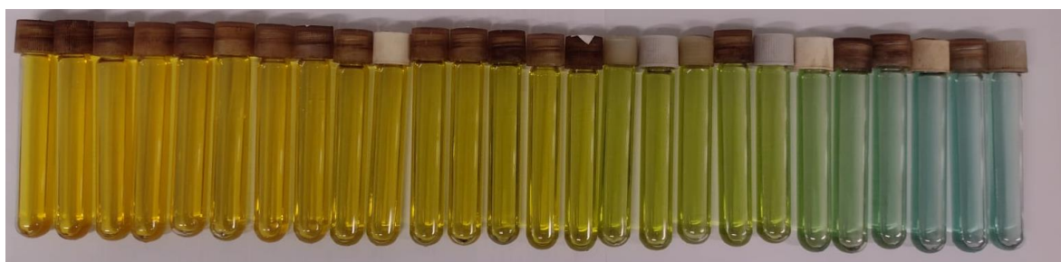
Figura 5: Soluções de calibração para determinação da DQO na faixa alta, com concentrações de 50 mg L -1 a 1000 mg L -1 , da esquerda para a direita.
