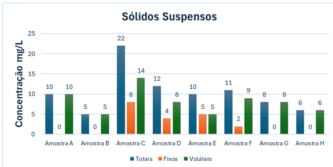
Figura 8: Resultados de Sólidos Suspensos Totais, nas frações fixas e voláteis, para amostras de água doce
