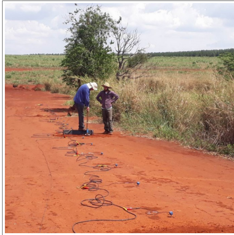
Figura 25 – Levantamentos de sísmica de refração com onda S em barragem
