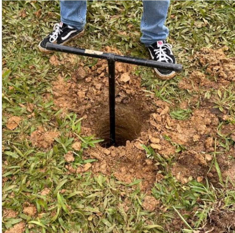
Figura 25 – Perfuração utilizando conjunto de hastes
