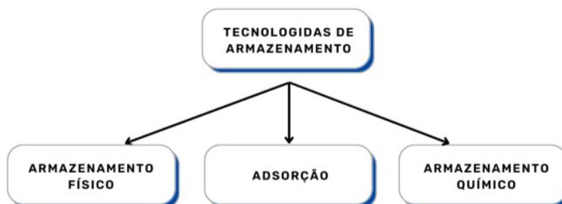
**Figura 5. Tecnologias de armazenamento de Hidrogênio**
