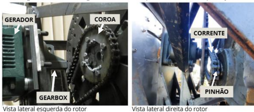
Figura 38 – Montagem do sistema primário de multiplicação
