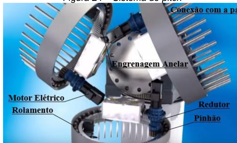
Figura 24 – Sistema de pitch
