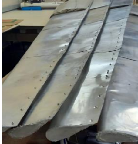
Figura 41 – Pás revestidas com chapa de alumínio
