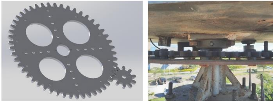
Figura 42 – Sistema de direcionamento da nacele ( yaw )
