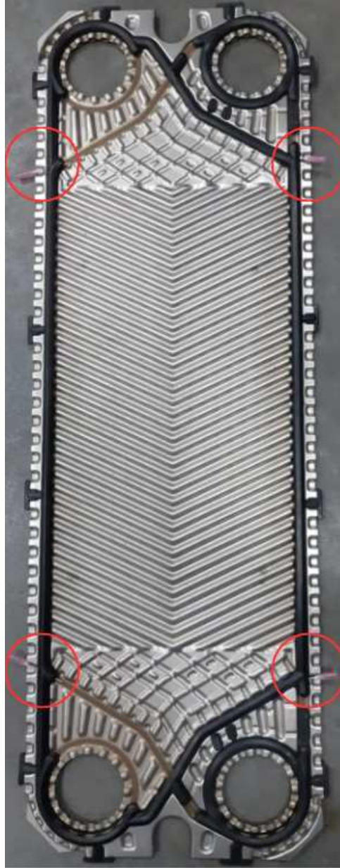
Figura 21 – Posição das agulhas em uma placa soldada.
