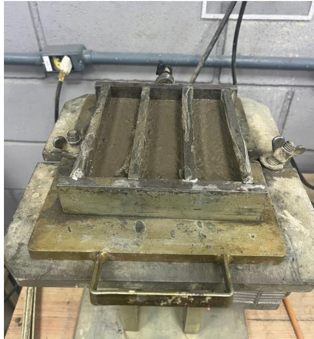
Figura 12 - Argamassa moldada na mesa de adensamento
