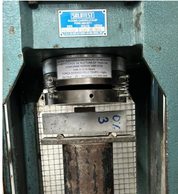
Figura 15 - Execução do ensaio de tração na flexão.
