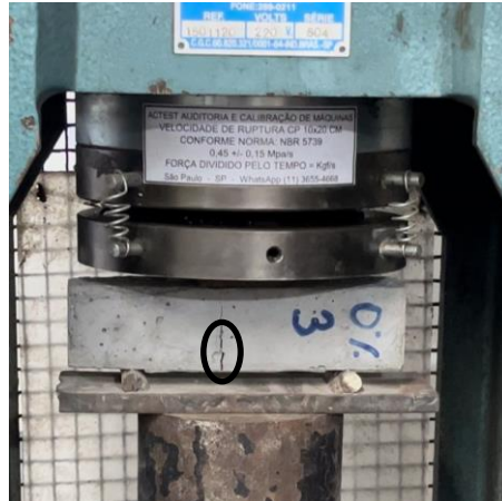
Figura 22 - Rompimento do corpo de prova no ensaio de tração na flexão
