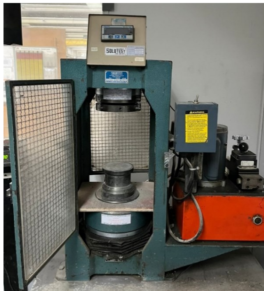
Figura 16 – Prensa hidráulica utilizada para os ensaios mecânicos.
