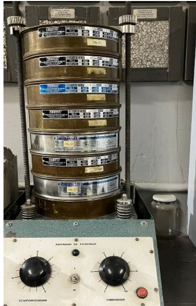
Figura 8 – Agitador de peneiras para determinação da distribuição granulométrica.
