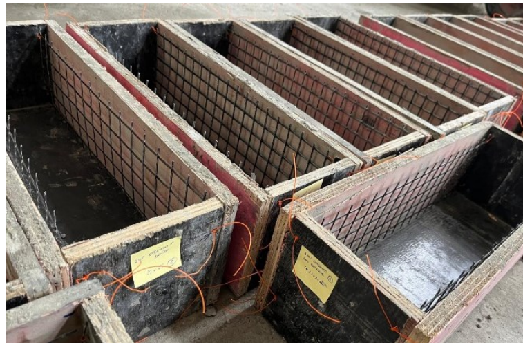
Figura 10 – Posicionamento das telas em fibra de carbono.
