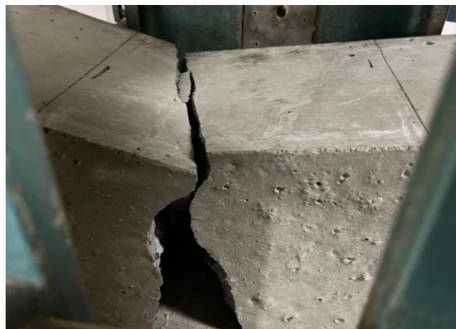
Figura 22 - Rompimento dos corpos de prova de referência.
