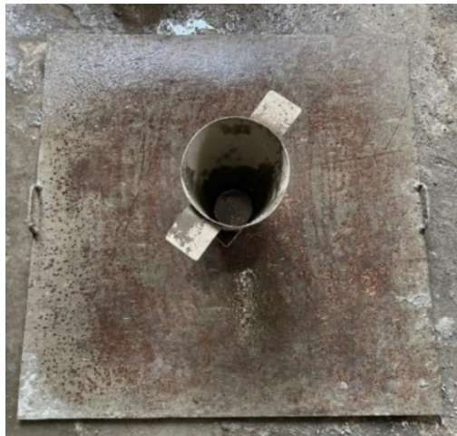
Figura 14 – Conjunto utilizado para espalhamento do concreto.
