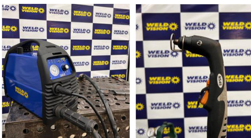
Figura 12 – Equipamento utilizado no jateamento: máquina de corte e tocha a plasma Flash
