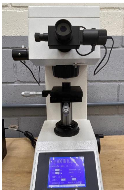
Figura 13 – Equipamento utilizado para perfil de microdureza HV
