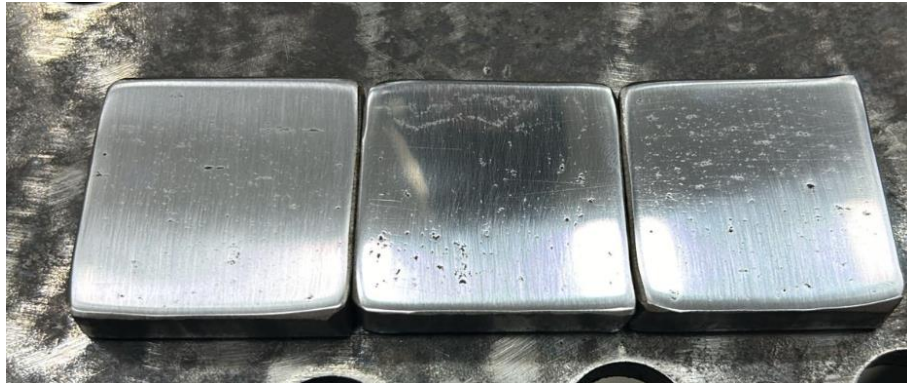
Figura 11 – Amostras preparadas para serem jateadas por plasma
