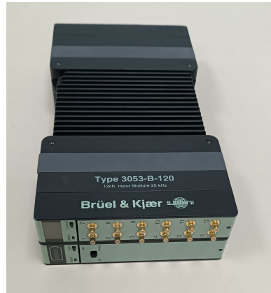
(b) Analisador Brüel &amp; Kjær 3053-B-120
