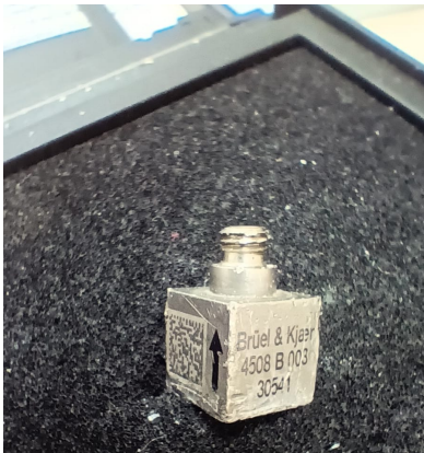
(a) Acelerômetro Brüel &amp; Kjær 4508B003 S/N:30541
