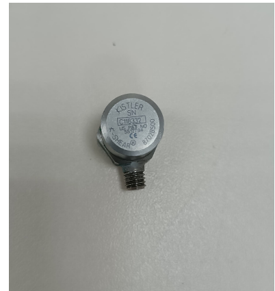
(c) Acelerômetro Kistler 8702B500 S/N:C118332
