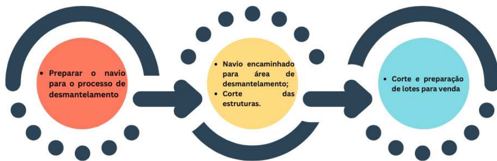
Figura 9 - Processo geral do desmantelamento
