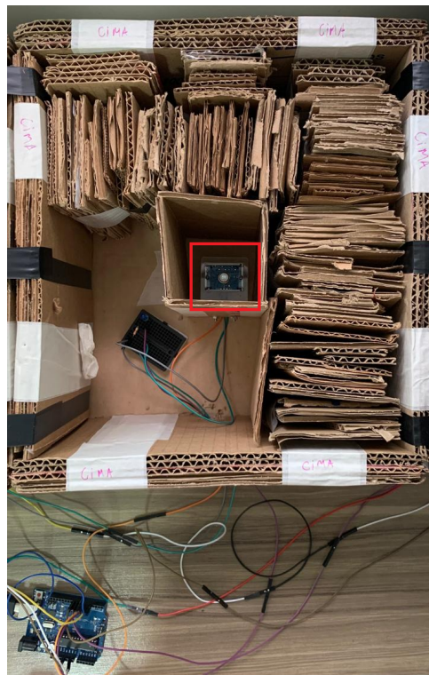
Figura 3 – Parte interna da tecla do Tapete Matemático
