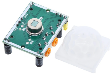
Figura 4 – Sensor Piroelétrico PIR - HCSR501 sem lente de Fresnel
