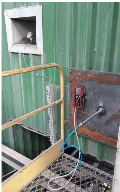
Figura 17 – Local e instalação do analisador de gases.
