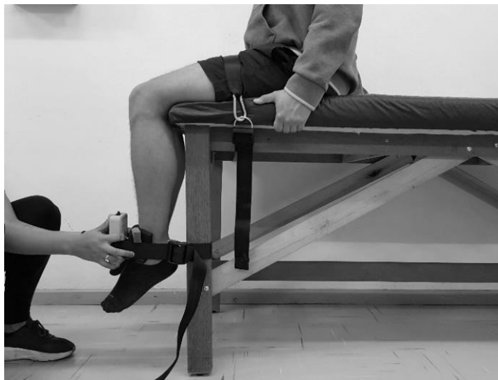
Figura 4 – Posicionamento do dinamômetro para coleta de dados de extensores de joelho
