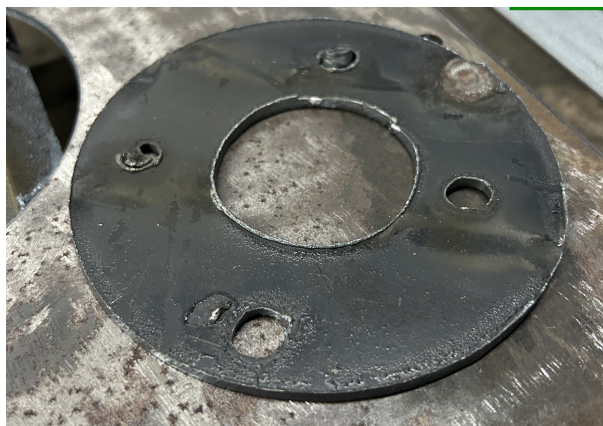
Figura 20 – Corte em chapa de espessura média
