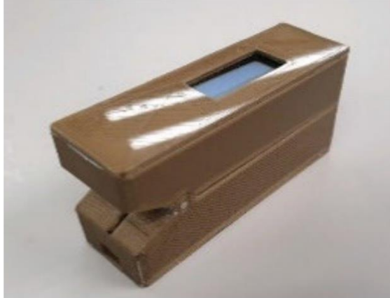
Figura 6: Monitor desenvolvido, encapsulado em um case 3D, com um display OLED de 0,91” para ser utilizado no dedo do usuário
